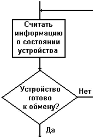
*Рис. 37. Цикл программного ожидания готовности внешнего устройства*
